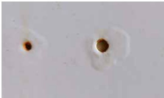
Kleine Bohrungen und Ausschnitte sind schwer zu verrunden, wie die Unterwanderung zeigt
