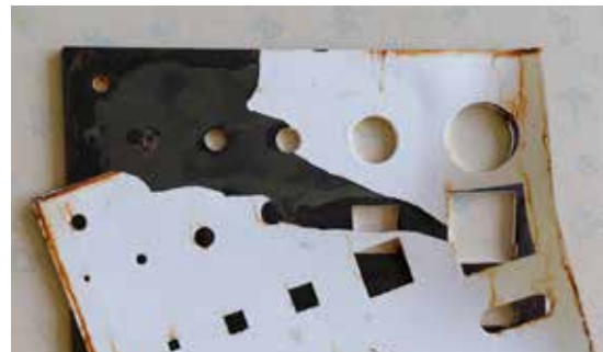
Probestück ohne Kantenverrundung; Vollenthaftung nach 250 h NSS
