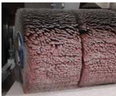
Schleiflamellenwalze (Quelle: www.blech-entgratung.de)
