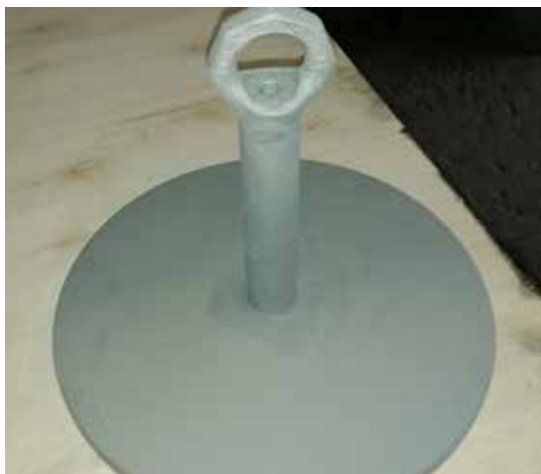
Kantig mit Korund gestrahltes Bauteil
