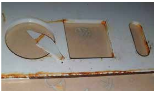
Versuchsblech mit abgeplatzter Beschichtung an der Laserkante
