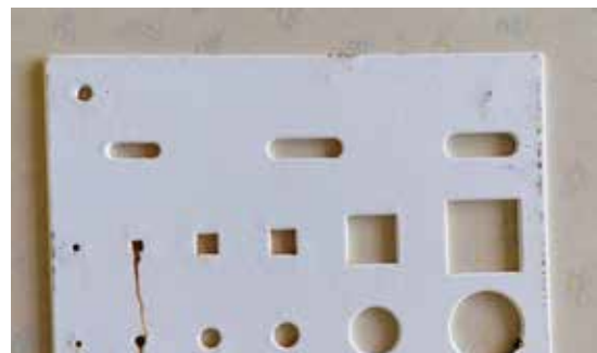
Probestück mit Kantenverrundung (0,5 mm); nach 500 h NSS lediglich kleine Korrosionserscheinungen
